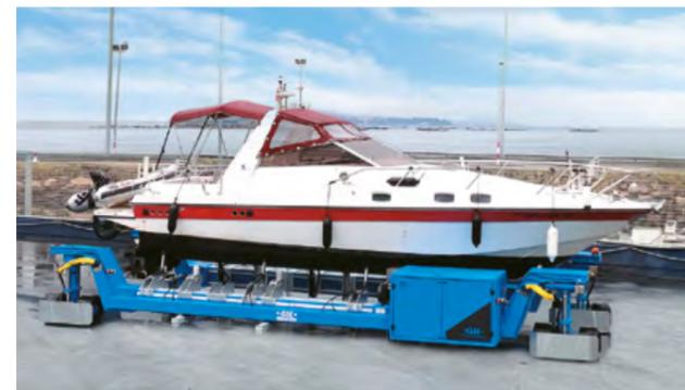
Este sistema permite el fácil desplazamiento de los barcos en dique seco, tanto para labores de almacenamiento en el varadero como para revisiones y mantenimiento.
